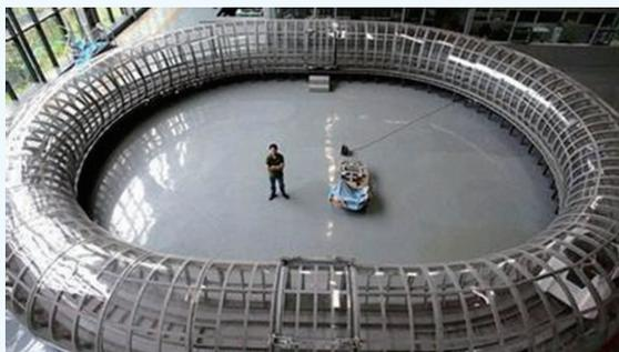
图12 首个载人的真空管道高温超导磁浮车系统
