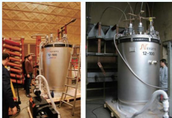
图14 Nexans公司研制的12 kV电阻型限流器
