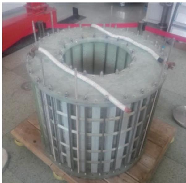
图20 1 MJ超导限流—储能系统的高温超导储能线圈
