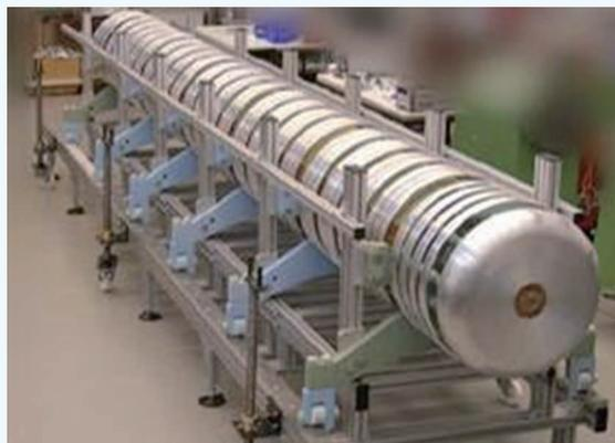
图15 美国超导公司115 kV/800 A电阻型限流器样机
