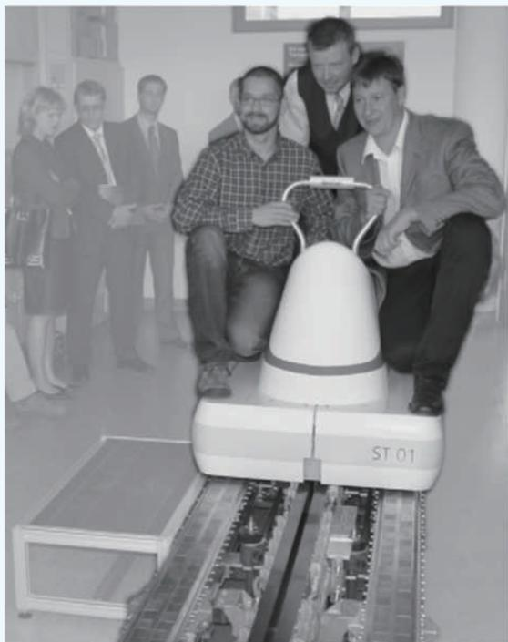
图10 德国 IFW 研究所研制的 SuperRapid 高温超导磁浮车
