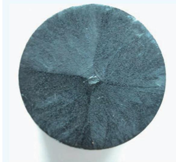
图 2 TSMTG法制备的YBCO块材样品
