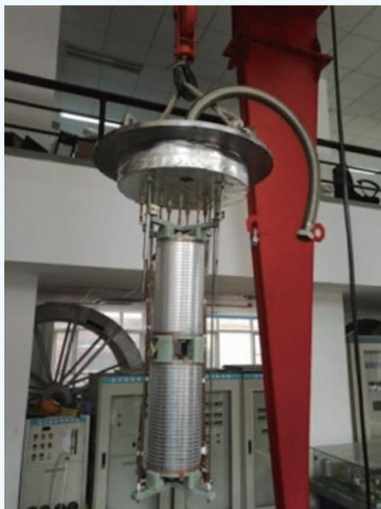
图16 10 kV/400 A电阻型超导直流限流器样机
