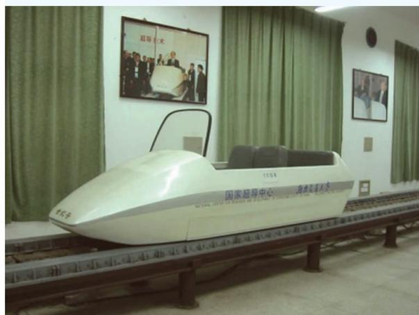
图9 西南交通大学研究的载人高温超导磁浮试验车
