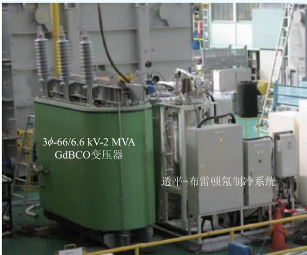
图18 日本2 MVA/66 kV/6.9 kV高温超导变压器实验现场
