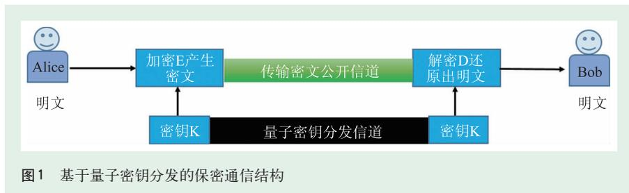
图1 基于量子密钥分发的保密通信结构
