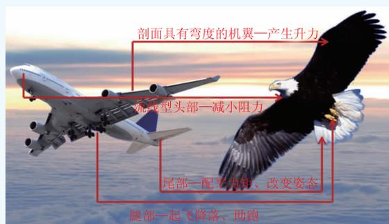
图5 鸟类飞行空气动力学对固定翼飞机设计的启示
